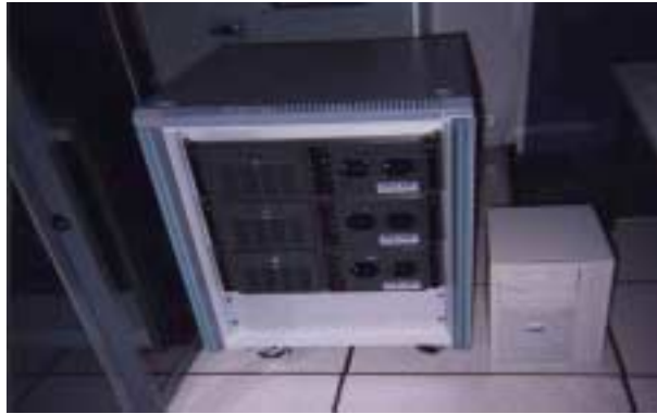
FIG. 2.2: PoPC : une grappe de 12 PC interconnectés par Myrinet.
