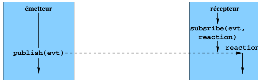
FIGURE 2.23 – Modèle de communication par événement
