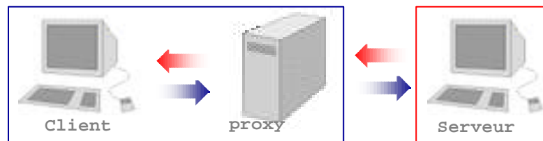
Figure 4 - Modèle Client-Serveur avec un proxy côté réseau mobile
